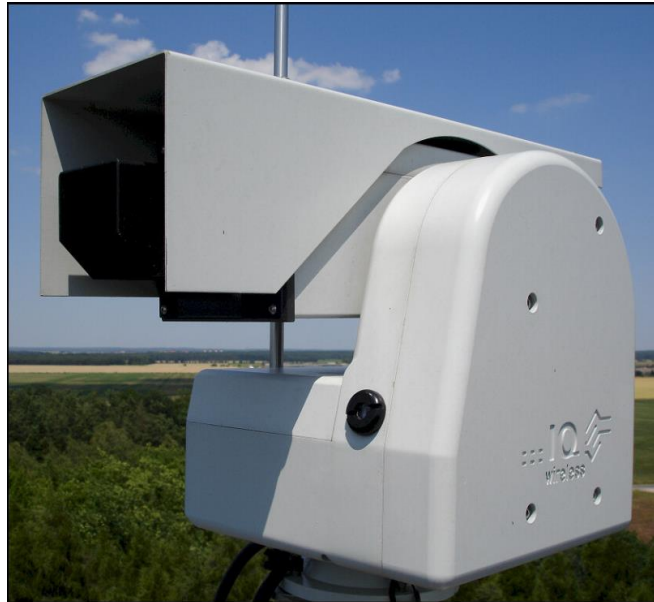
Abb. 3: Detektionseinheit des AWFS-Systems (Quelle: wald.sachsen.de)
